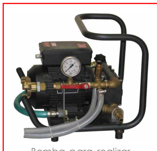
Bomba para realizar pruebas hidráulicas a mangueras BIEs.
