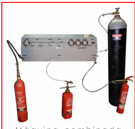
Máquina combinada para pruebas hidráulicas de extintores de POLVO y CO 2 y carga de CO 2 .
