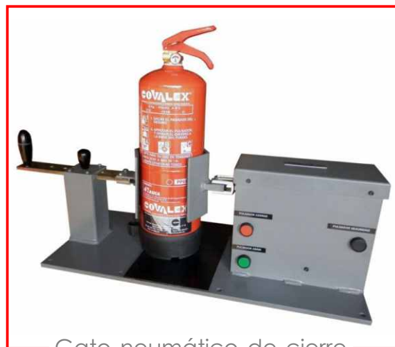
Gato neumático de cierre rápido para la sujeción de extintores de polvo.
